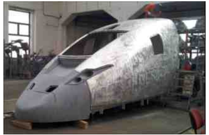
Prototip njemačkog brzog vlaka ICE od zavarenog sendviča s upjenjenom aluminijevom jezgrom
