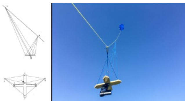
Slika 2. Picavet: skica (lijevo) i fotografija tijekom leta (desno)
